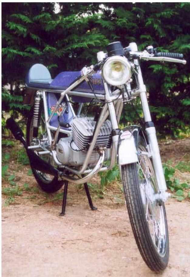
Sur le plan de la mécanique, le moteur Minarelli P6 est équipé d'une bielle à cage argent et d'un cylindre Fantic en 80 cm<sup>3</sup>, allumage électronique, embrayage à taille droite, le tout alimenté par un carburateur Dell'Orto VHBZ de 24 mm, gicleur de 120 à 130.
