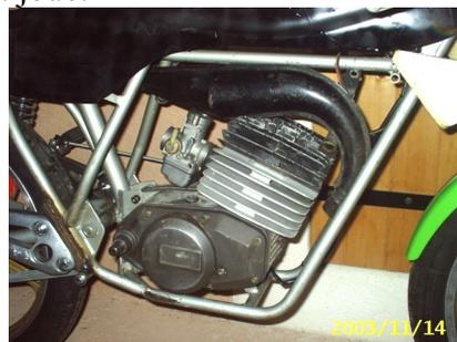
Une jolie plaque d'aluminium, coupe et recoupe, voilà deux belles platines de repose-pieds du plus bel effet. On assemble le tout pour voir. Le pot Fantic est au poil pour une sortie d'échappement sous la selle, mais pas moyen de trouver le coude d'échappement de Caballero TX160 nécessaire à son montage définitif. On abandonne pour plus classique avec un coude de Fantic GT Super Six, un pot de détente Lafranconi, et une patte de fixation supplémentaire.
